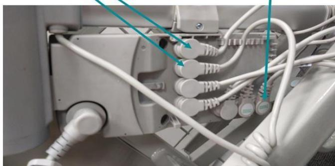
3.8 Vous pouvez maintenant utiliser la télécommande pour soulever le lit, l'ajuster, etc. Les commandes du dispositif sont indiquées ci-dessous. Assurez-vous également que la clé de sécurité est insérée dans le dispositif. Le dispositif ne fonctionnera pas si la clé de sécurité n'est pas insérée.
